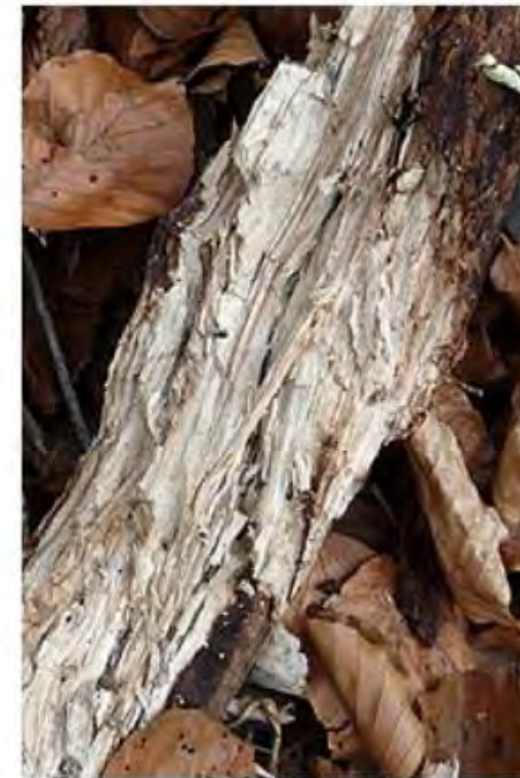
La pourriture blanche sélective ramollit le bois et le rend fibreux. C'est ainsi qu'il se décolore. Photo: Thomas Reich (WSL)
