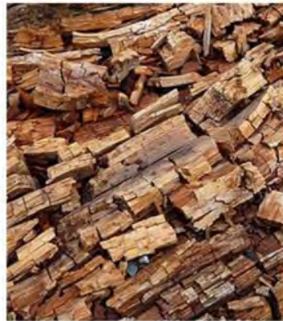
La couleur brune et la décomposition cubique sont des signes typiques de la pourriture brune. Photo: Thomas Reich (WSL)
