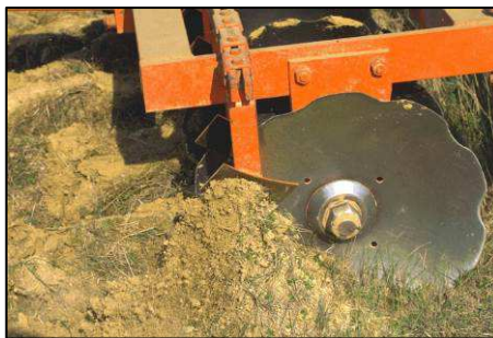
Disque qui rentre de 5 à 15 cm dans le sol.
